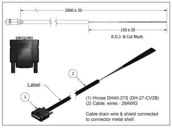
Figure 37: DH60-27P Cable No. OR-YXCC-27BE2M1 Detail
