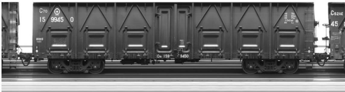
系统可用多套线扫描相机和 3D 传感器，线扫描相机分别安装在龙门架的左右两侧和顶部，配合大功率激光器照明，对车辆顶部和两侧进行完整取像，并检测关键部位的异常。3D 传感器安装在龙门架顶部，重构货物轮廓，检测货物装载情况。
